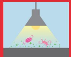
Durch sichtbares Licht wird der Photokatalysator in der Beschichtung angeregt und überträgt die Energie an den umgebenden Sauerstoff. Aktivierter Sauerstoff entsteht. Dieser tötet Mikroorganismen schnell und effektiv.
